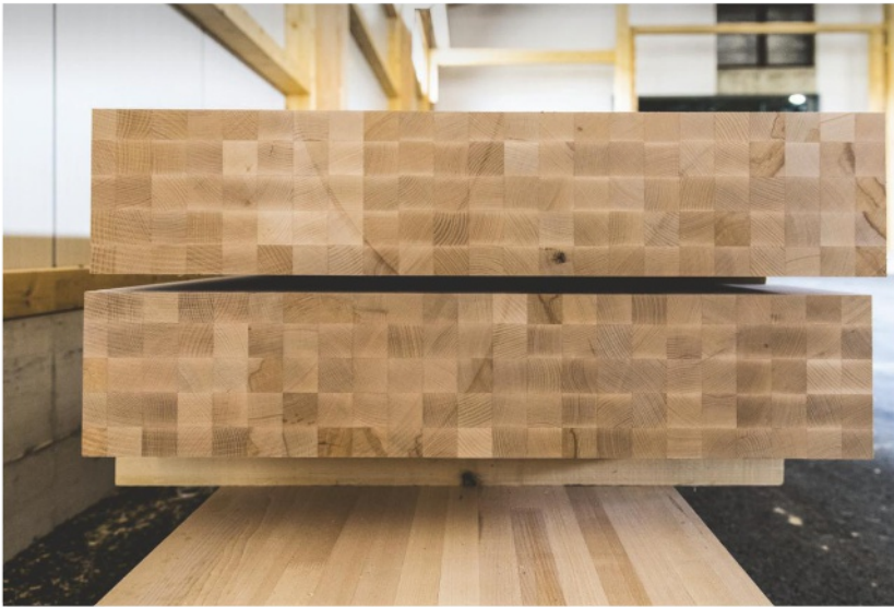
Im neuen Werk der Fagus Suisse AG in Les Breuleux werden Latten aus Buche und anderen einheimischen Laubhölzern sortiert, gehobelt und zu hochfesten Balken verklebt
